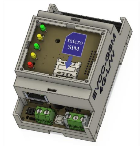
Рисунок 5.21. Установка SIM-карти в GSM-модуль
