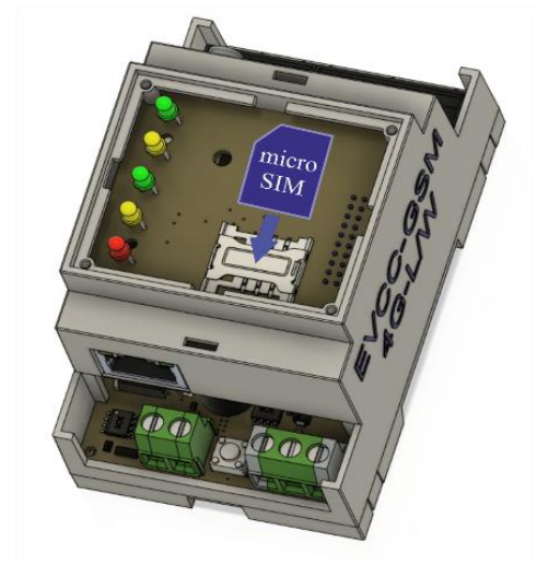
Рисунок 5.21. Installing a SIM-card into the GSM-module
