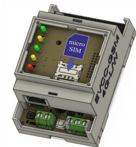
Рисунок 5.21. Установка SIM-карты в GSM-модуль
