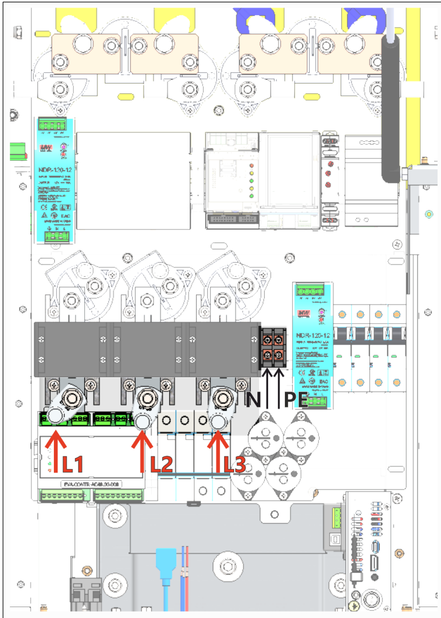
Рисунок 5.5 Схема подключения силового кабеля
