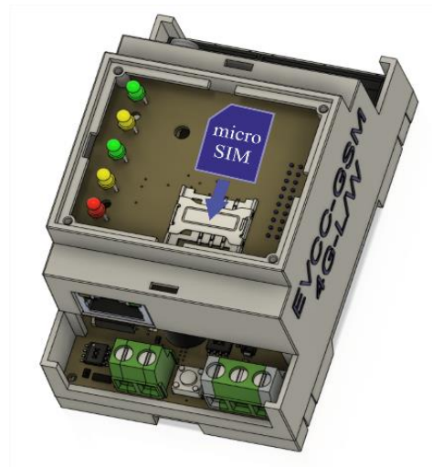
Рисунок 5.21. Установка SIM-карты в GSM-модуль
