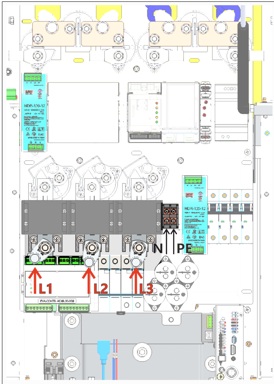
Рисунок 5.5 Схема підключення силового кабелю
